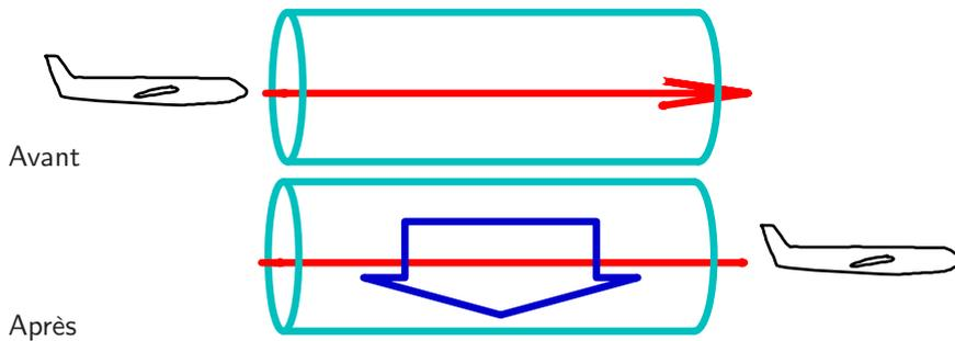
FIGURE C.2. Un avion rencontre un tube d'air stationnaire. Une fois l'avion passé, l'air a été envoyé vers le bas par l'avion. La force exercée par l'avion sur l'air pour l'accélérer vers le bas est égale et opposée à la force exercée sur l'avion par l'air.
