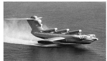
FIGURE C.16. Le Lun, un ékranoplane — un peu plus long et lourd qu'un Boeing 747.
