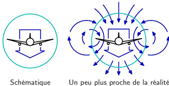
FIGURE C.3. Notre schéma considère que l'avion laisse une saucisse d'air en mouvement vers le bas dans son sillage. Une représentation plus réaliste implique un flux tourbillonnant complexe. Pour le voir en vrai, regardez la figure C.4.
