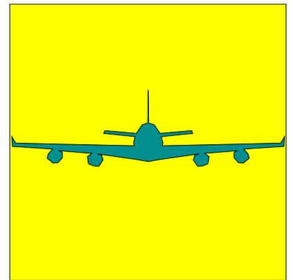
FIGURE C.7. Vue frontale d'un Boeing 747, utilisée pour estimer l'aire frontale  $S_a$  de l'avion. La surface du carré est  $S_s$  (l'envergure au carré).
