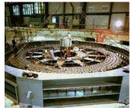
FIGURE 26.15. Un des deux volants d'inertie au centre de recherche sur la fusion de Culham, en construction. Photo : EFDA-JET. [www.jet.efda.org](http://www.jet.efda.org).
