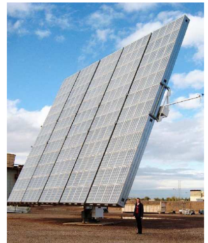
FIGURE 25.9. Un collecteur photovoltaïque à concentration de 25 kW (crête) produit par la société californienne Amonix. Son ouverture de 225 m 2 contient 5 760 lentilles de Fresnel avec une concentration optique d'un rapport 260, chacune illuminant une cellule de silicium au rendement de 25 %. Un tel collecteur, placé sur un site désertique approprié, génère 138 kWh par jour — assez pour couvrir la consommation d'énergie de la moitié d'un Américain. Remarquez l'homme en bas qui donne l'échelle. Photo de David Faïman.
